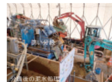
図3 土壌洗浄分級プラント佐藤工業、若築建設、筑波大学による共同開発
