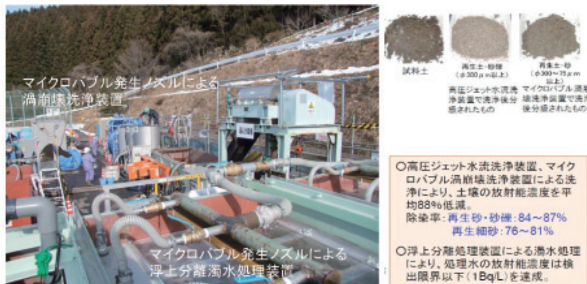
図1 福島県白河市における佐藤工業・若築建設および筑波大学との共同による実証試験（左）と結果（右）
