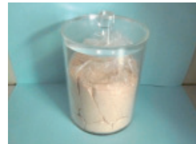
写真2 放射性物質濃度測定に使用するマリネリ容器
