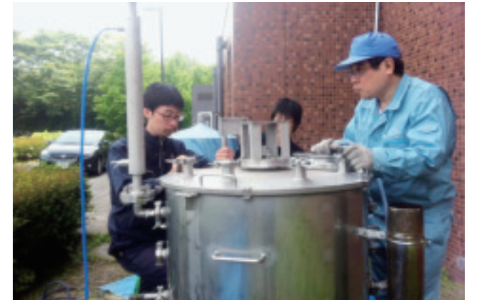
循環型蒸煮・蒸留器の試運転の様子
